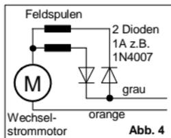
Alternativ dazu können Sie den Wechselstrommotor durch den Einbau eines HAMO-Dauermagneten in einen Gleichstrommotor umbauen. Die Feldspulen und die Dioden sind dann nicht mehr nötig. Die Lastregelung kann hierbei wieder genutzt werden.
