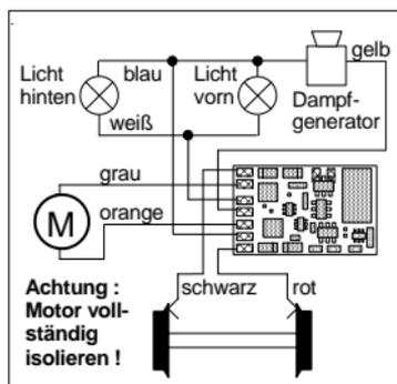
Um bei dem Decoder T125 eine Zusatzfunktion (z.B. Dampfgenerator) anzuschließen, müssen die Funktionsausgänge auf richtungsunabhängigen Betrieb programmiert werden. Die Einstellung erfolgt im User-Konfigurationsregister 1 (CV#56). Dazu ist in diesem Register Bit 0 zu setzen.
